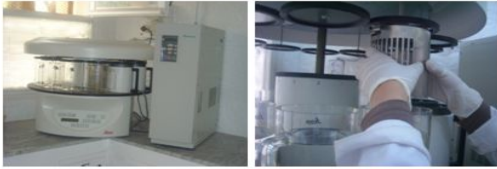
Figure 13. Automate d'inclusion (laboratoire de l'anatomopathologie d'el khroub).
